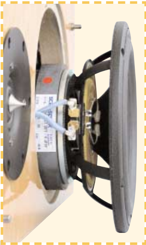
180-mm głośnik nisko-średniotonowy z serii Revelator to jedna z najnowszych i najlepszych osiemnastek Scan Speaka
