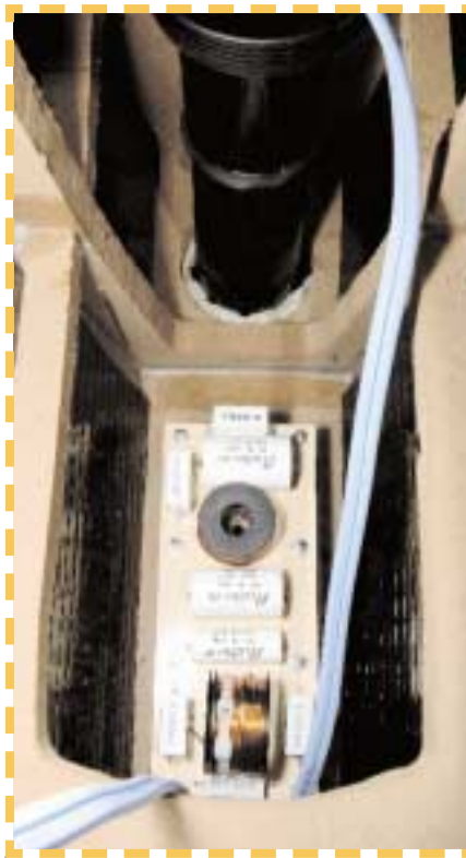
Zwrotnica zajmuje dwie płytki drukowane. Obfite ożebrowanie obudowy zwiększa jej sztywność, zaś maty bitumiczne sprawiają, że ścianki są mniej podatne na rezonanse
